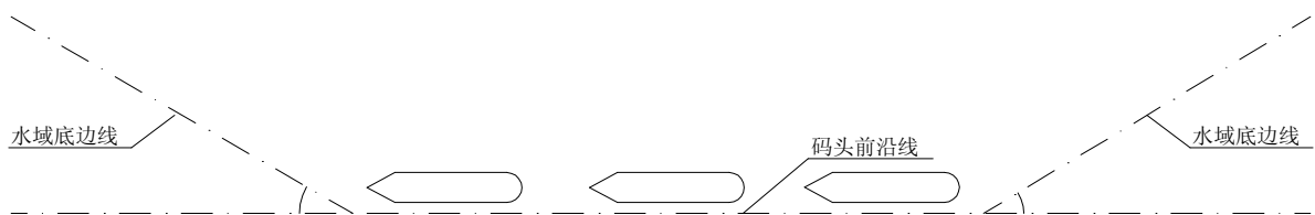
图3.2.2 顺岸码头端部泊位的水域底边线与码头前沿线夹角示意图
